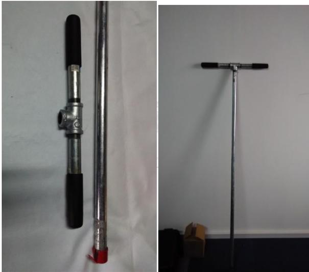
3. 如果需要通过绳缆采样，则将绳缆连接到头部组件上的卸扣上，并将组装好的采泥器下放到水底即可，当你感受到绳缆突然松弛则说明采泥器已扎到底并可以回收了。
