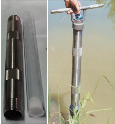
2. 如果是浅水采样需要加装推杆：可将头部组件把手两端的延长杆卸下，将推杆（如果需要加长则可以通过双螺口管箍将各推杆连接起来）安装到头部组件并安装好取样管等其他部件后再使用。同样只需将采泥器下放到水体中并向下将其插入底泥中即可采集样品。回收过程同样需要尽量保持采泥器的垂直状态。
